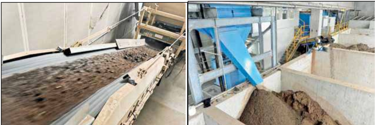
Figura 4: Impianto di trattamento terre - Soil washing
